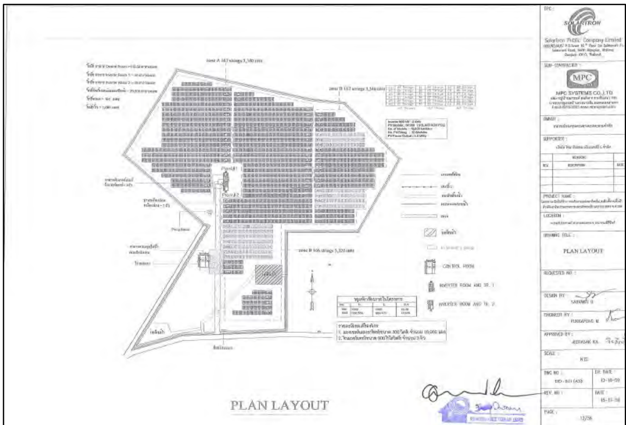
แผนผังตำแหน่งอุปกรณ์ (Lay out) โรงไฟฟ้าพลังงานแสงอาทิตย์ ขนาด 3 MW สหกรณ์กองทุนสวนยางบางสะพาน
