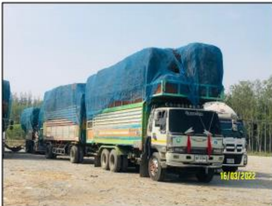
รูปที่ 2-9 รถบรรทุกเชื้อเพลิงมีการปิดคลุมผ้าใบหรือตาข่ายกันฝุ่น เพื่อป้องกันฝุ่นละออง (1)
