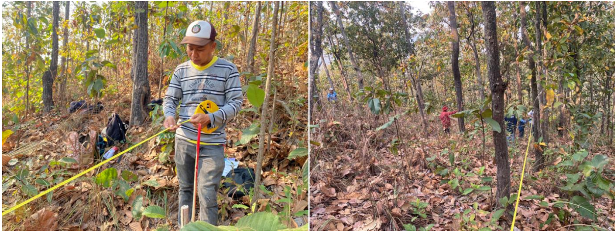
ภาพที่ 10 เทปวัดกำหนดแนวหลัก (Base Line) ของแปลงตัวอย่าง
