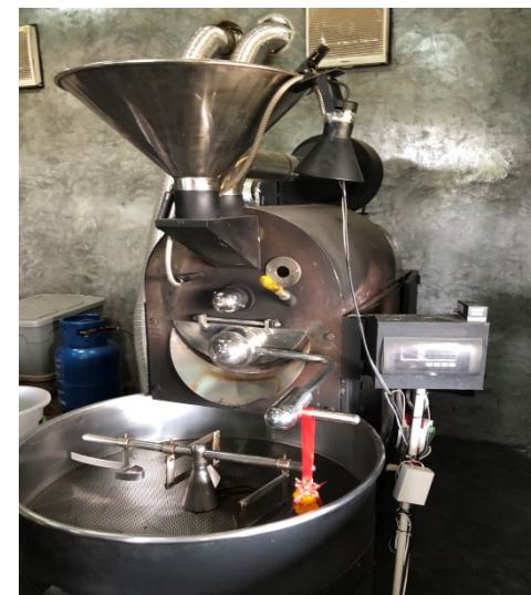
การติดตั้งเซนเซอร์วัดกระแสไฟฟ้าและความร้อนในมอเตอร์เครื่องคั่วกาแฟ
