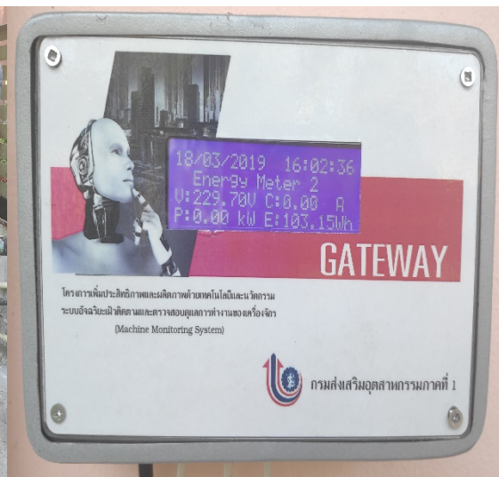
การติดตั้งเซนเซอร์ตรวจวัดการใช้พลังงานของปั๊มลม
