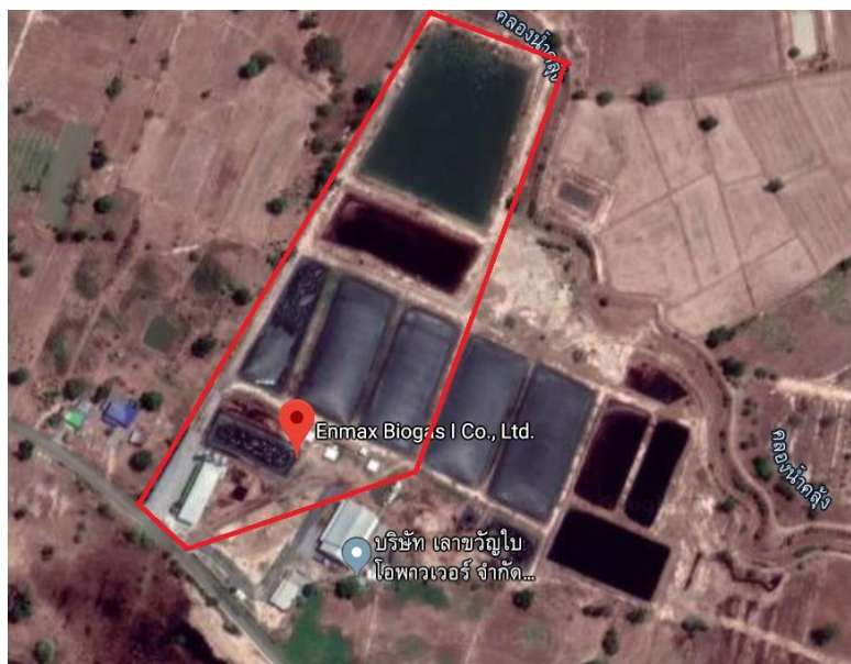
รูปที่ 1.2 ระบบบำบัดน้ำเสียแบบไร้อากาศ และอาคารผลิตไฟฟ้า
