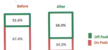
ภาพก่อนและหลังส่วนปรับปรุงการเดินเครื่องทำน้ำแข็งช่วง On Peak & Off Peak ก่อนและหลังการปรับปรุง ( 01/04/2564 - 31/08/2565)
