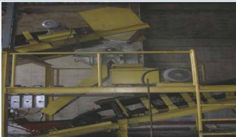
เครื่องย่อยปุ๋ยอินทรีย์ (breaker)
