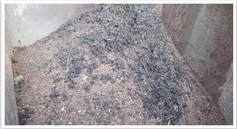
รูปที่ 4.24 ลักษณะเถ้าที่เกิดขึ้นจากการเผาไหม้ชีวมวล
