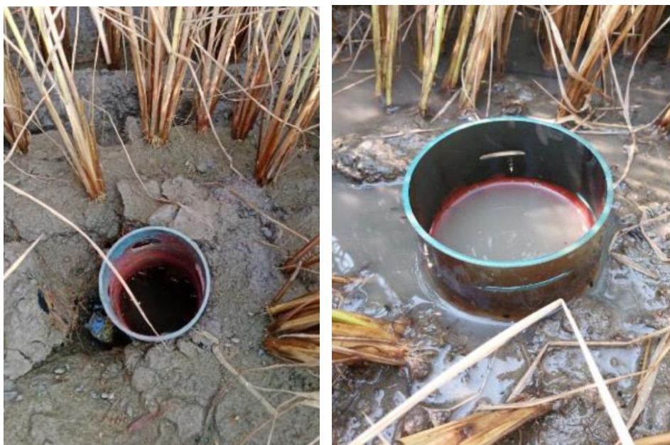
ภาพประกอบที่ 1.7 การบันทึกภาพระดับน้ำในท่อนวัดระดับน้ำตามตำแหน่งค่าพิกัดทางภูมิศาสตร์ของแปลงนาข้าวที่ร่วมโครงการ
