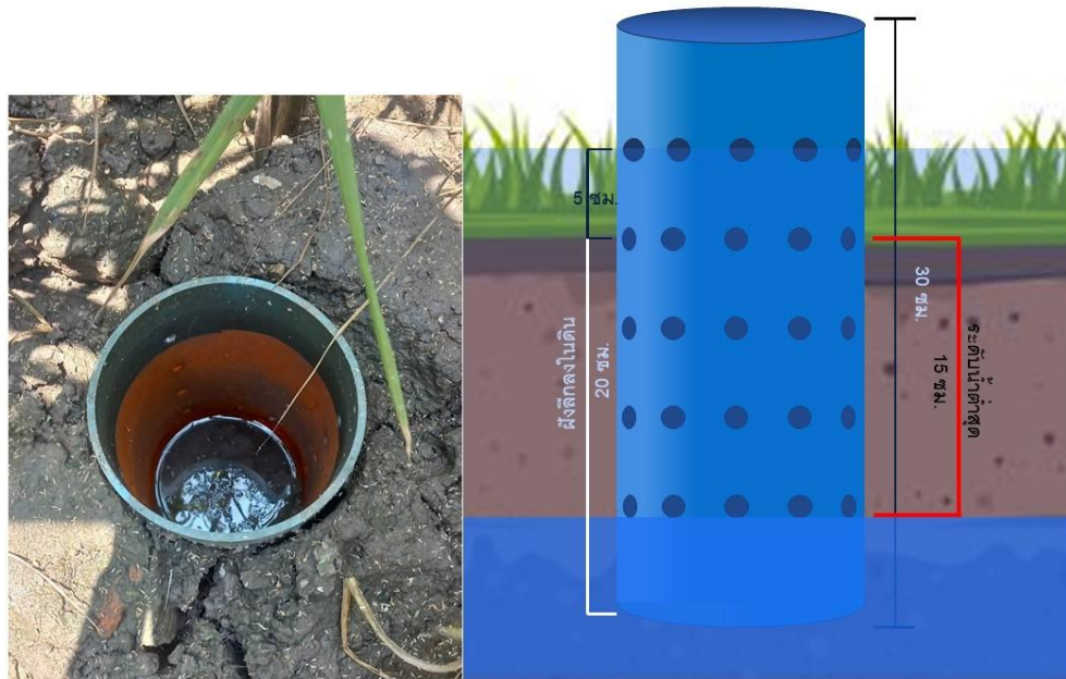
ภาพประกอบที่ 1.6 รูปแบบการฝังท่อวัดระดับน้ำเพื่อใช้ติดตามและประเมินระดับน้ำในดินของนาข้าว
