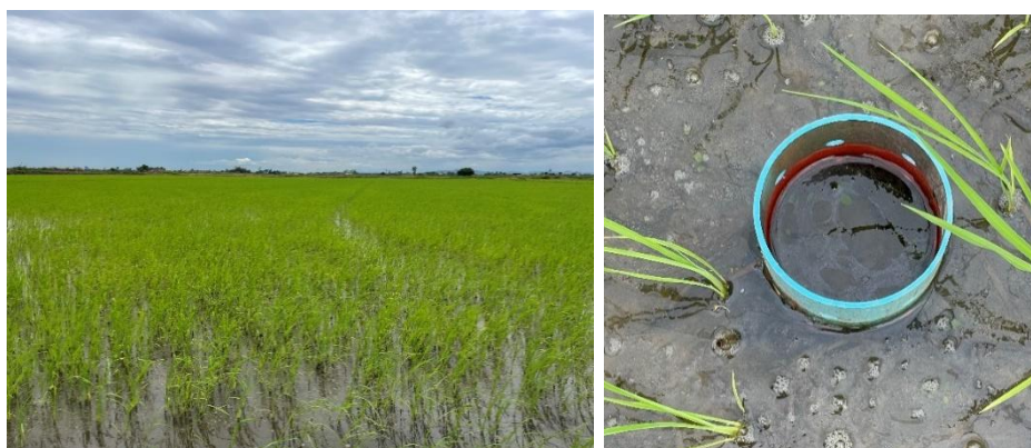
ภาพประกอบที่ 1.3 สภาพการขังน้ำและท่อแสดงระดับน้ำในดินของ
