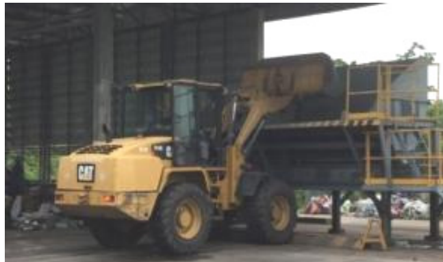
2. จุดรับขยะและตักเข้าระบบสายพาน
