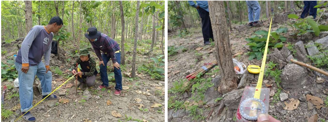
ภาพที่ 8 เทปวัดกำหนดแนวหลัก (Base Line) ของแปลงตัวอย่าง
