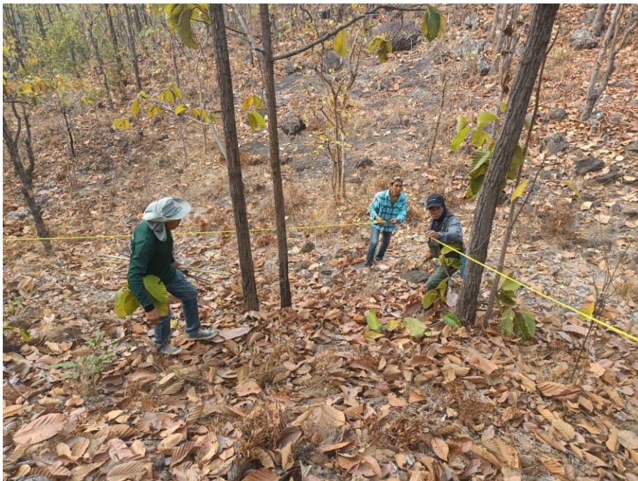
ภาพที่ 13 เทปวัดกำหนดแนวหลัก (Base Line) ของแปลงตัวอย่าง
