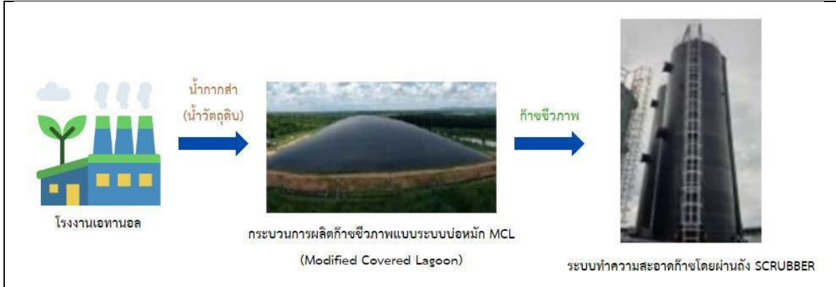
รูปที่ 3 ระบบผลิตก๊าซชีวภาพ
