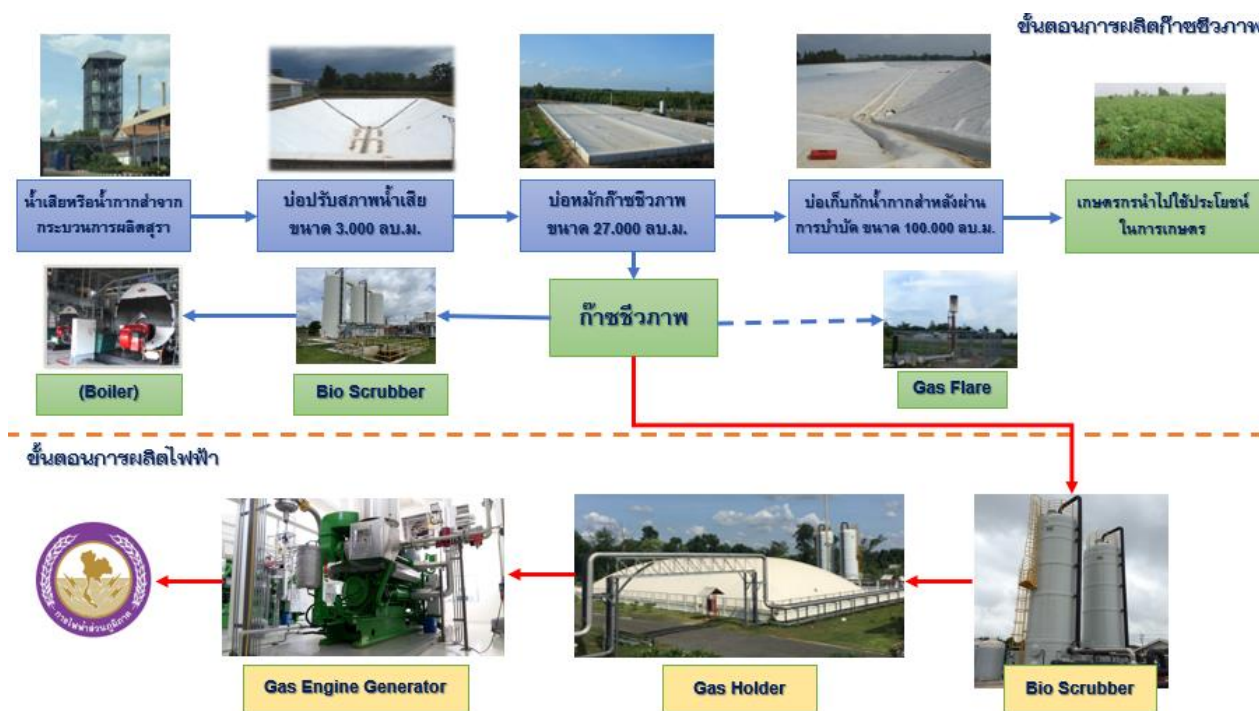
รูปที่ 2-2 ขั้นตอนการผลิตก๊าซชีวภาพและการนำก๊าซชีวภาพไปใช้ประโยชน์
