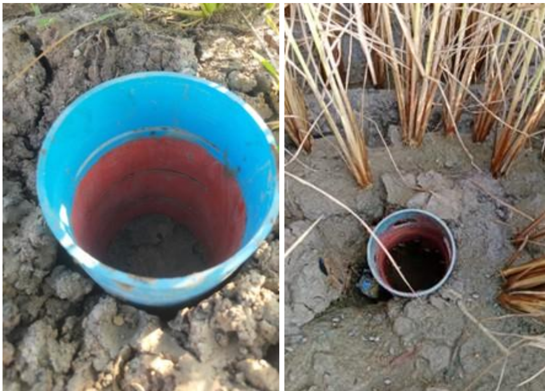
ภาพประกอบที่ 6-1 ตัวอย่างท่อเจาะรูตรวจสอบระดับน้ำของเกษตรกรที่เข้าร่วมโครงการ
